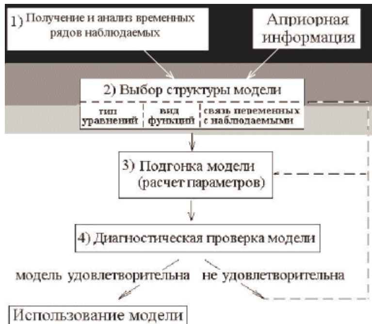
Рис.1. Типовая схема процесса моделирования по временному ряду
