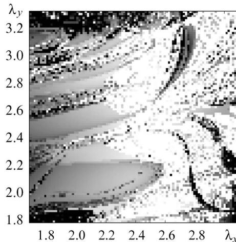
Рис. 2. Зависимость точности реконструкции параметров  $\Delta_r$  системы (1) от стартовых догадок для параметров нелинейности  $\lambda_x$  и  $\lambda_y$  при фиксированных стартовых догадках для параметра связности  $k' = 0.3$  и стартовых догадках для скрытой переменной на времени запаздывания. Белый цвет соответствует  $\Delta_r = 0$ , чёрный цвет –  $\Delta_r \geq 1$ , различные градации серого – промежуточным значениям  $0 < \Delta_r < 1$
