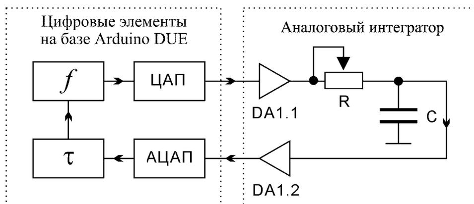
Рис. 5. Блок-схема генератора с запаздыванием на Arduino DUE
