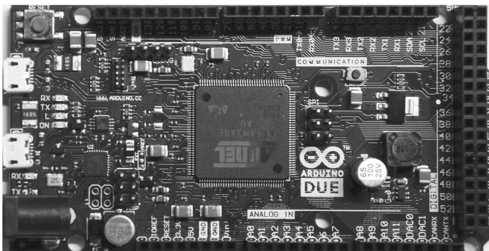
Рис. 2. Внешний вид Arduino DUE
