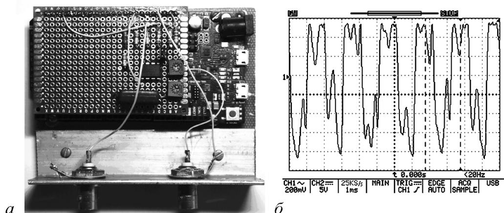
Рис. 6. *а* – фотография лабораторной установки – генератора с запаздывающей обратной связью, описываемого уравнением (1). Аналоговый интегратор (см. рис. 5) собран в виде мезонинной платы над платой Arduino DUE, реализующей цифровые преобразования. *б* – временная реализация генератора в хаотическом режиме
