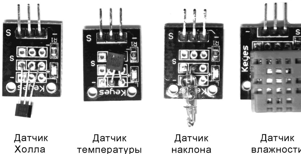
Рис. 4. Некоторые датчики платформы Arduino
