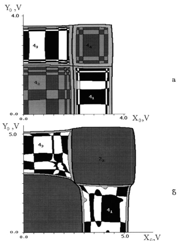
**Рис. 2.** Бассейны притяжения хаотических аттракторов экспериментальной системы при значениях: *a* —  $\lambda = 1$  В,  $k = 0.002$  мс; *b* —  $\lambda = 1.79$  В,  $k = 0.025$  мс.
